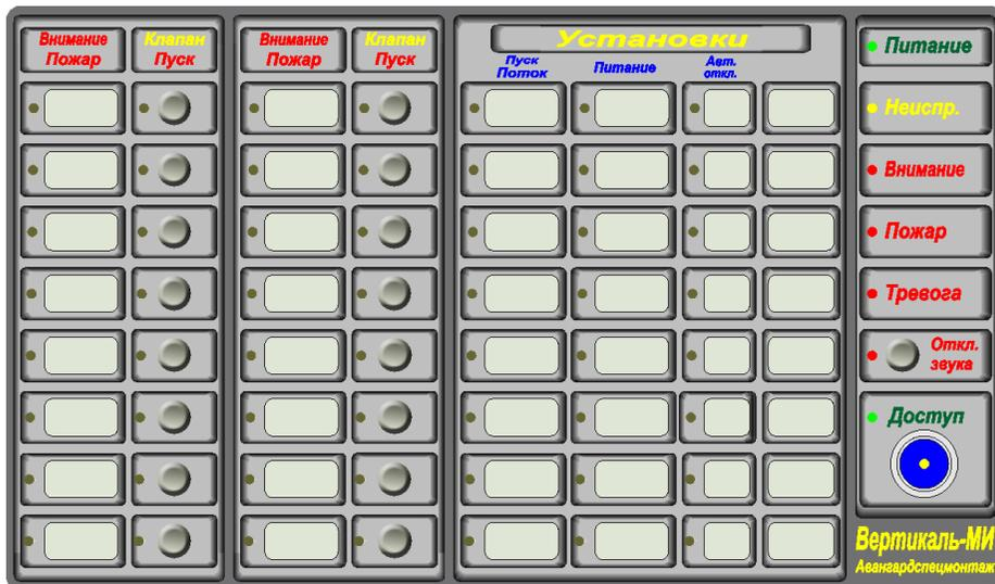
Рис.3 – Лицевая панель типичного «Вертикаль-МИ» для систем дымоудаления и пожарной сигнализации
