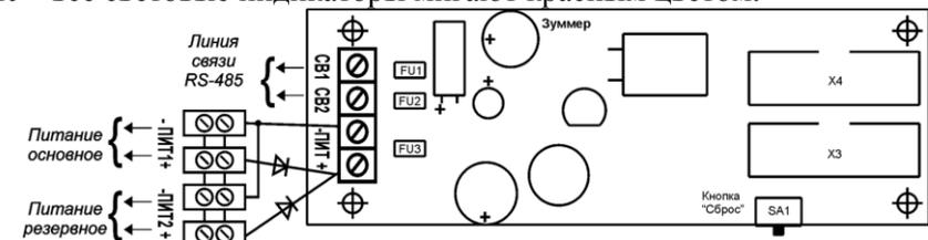
Рис.1 – Монтажная схема «Вертикаль-МИ»
