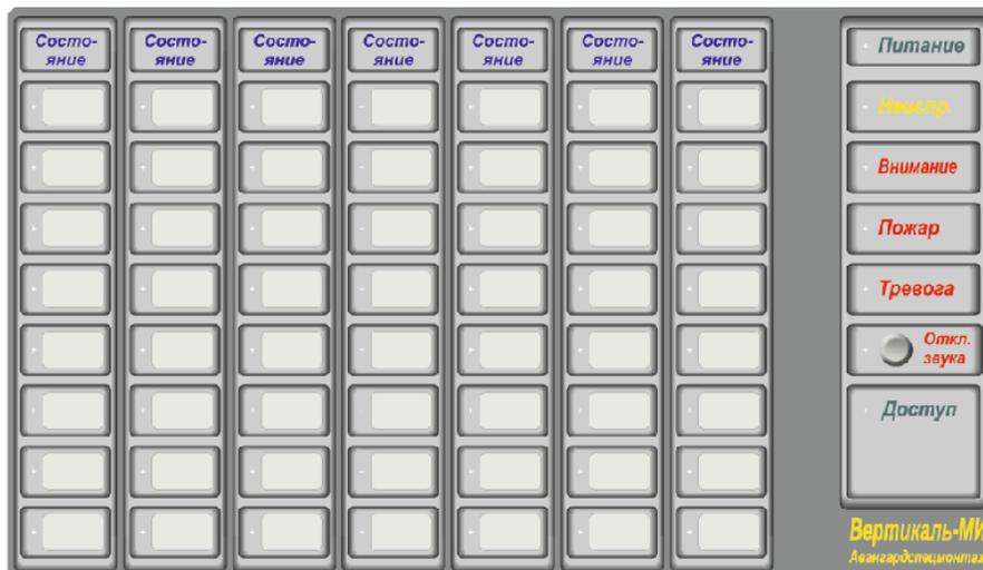
Рис.4 – Лицевая панель типичного «Вертикаль-МИ» для систем адресной пожарной сигнализации
